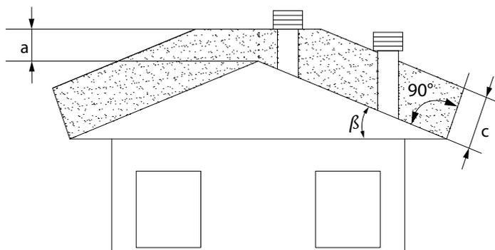
**Zona di rispetto per a quota di sbocco sopra il tetto in pendenza ( β >10°)**
