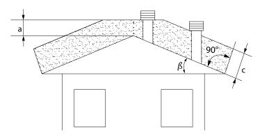
Zona di ·rispetto per a quota di sbocco sopra il tetto in pendenza ( $\beta > 10^{\circ}$ )
