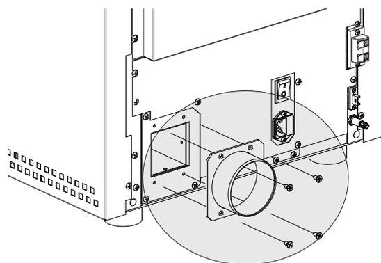
La prolunga della canalizzazione si trova nella confezione dei accessori internamente alla stufa. Il montaggio avviene tramite 4 viti che sono in dotazione.
