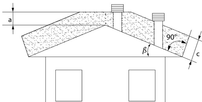
**Zona di rispetto per a quota di sbocco sopra il tetto in pendenza ( $\beta > 10^\circ$ )**
