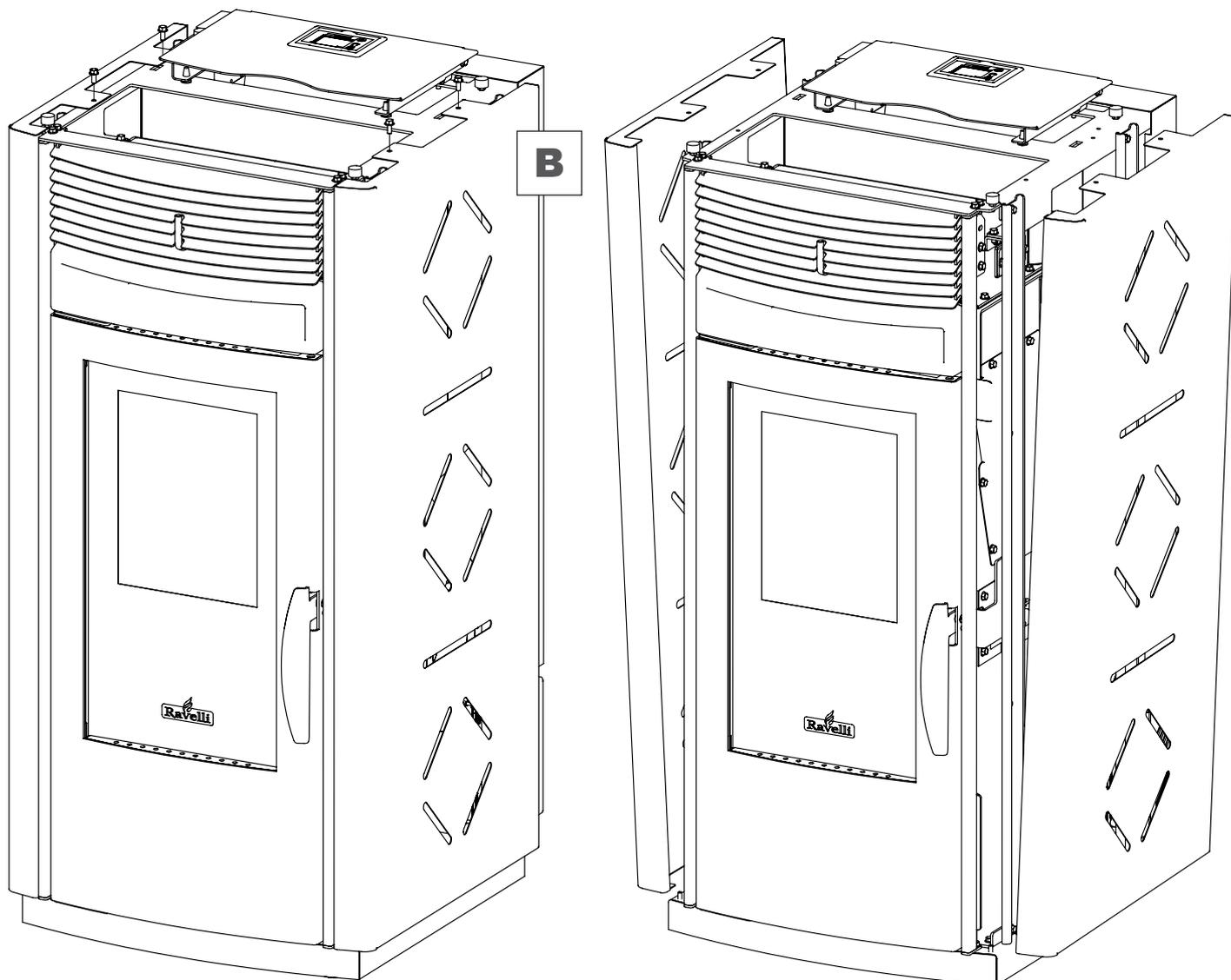
**Accesso al debimetro / Access to the flowmeter / Accès au débitmètre / Zugang zu den Flussmassenmesser / Acceso al caudalímetro / Adgang til flowsensor**
