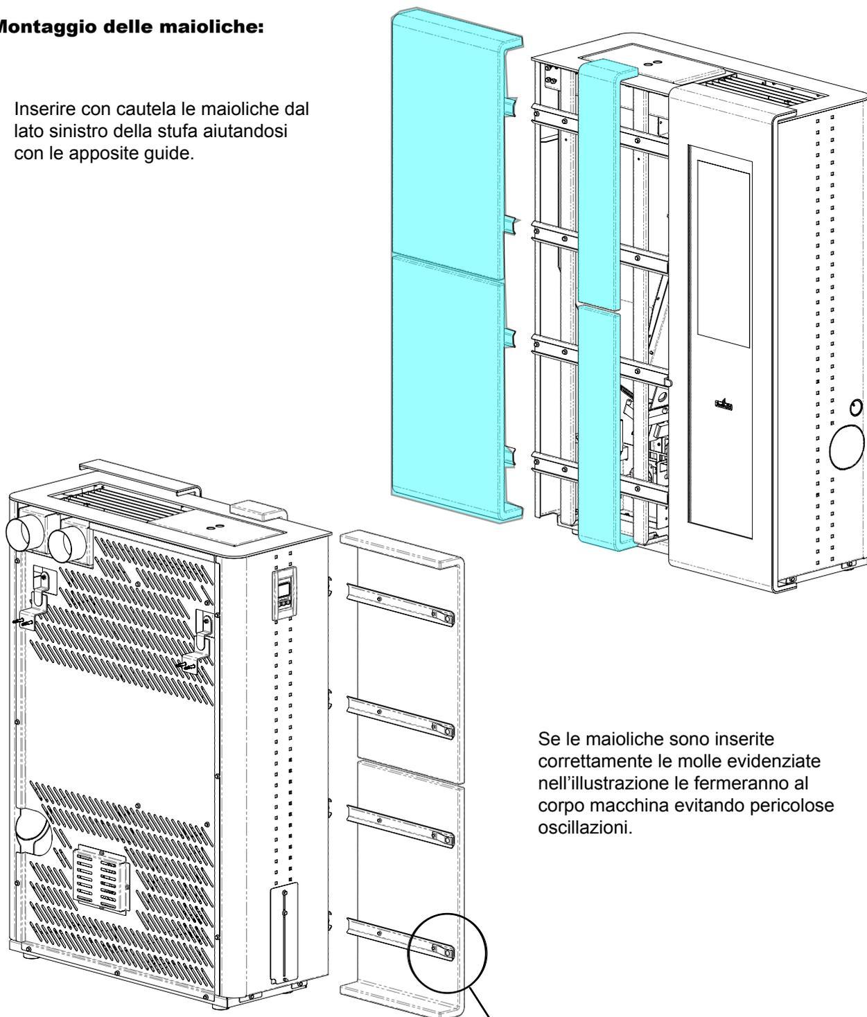
Se le maioliche sono inserite correttamente le molle evidenziate nell'illustrazione le fermeranno al corpo macchina evitando pericolose oscillazioni.
